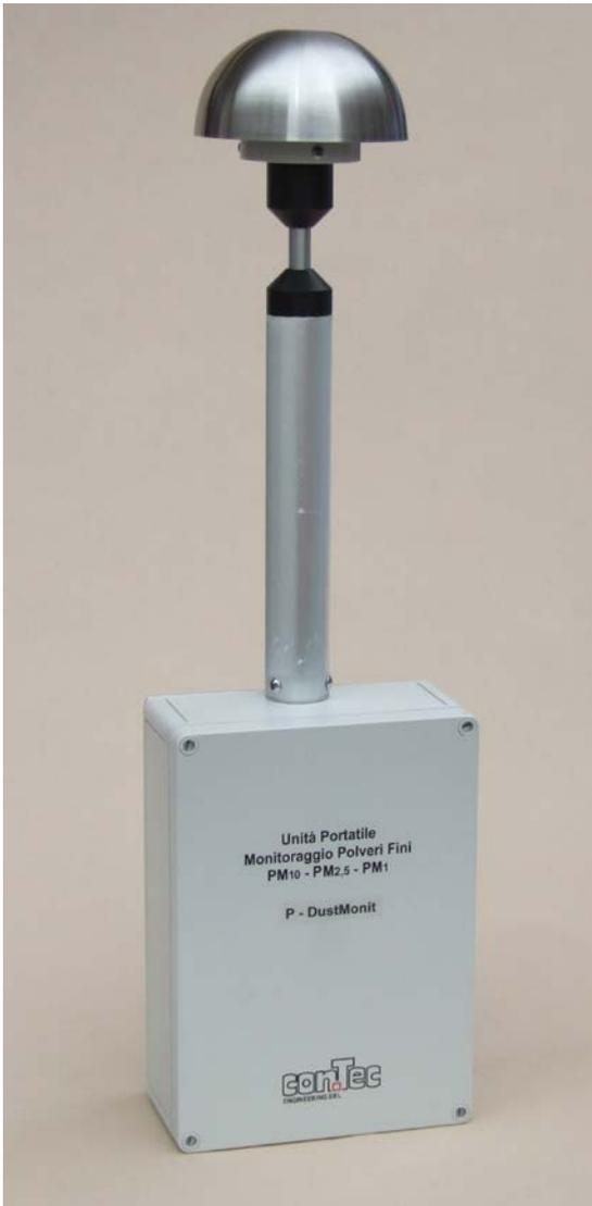
L'unità di monitoraggio polveri P-DustMonit è uno strumento per la misura e la registrazione in continuo delle particelle presenti nell'aria.
